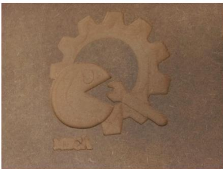
Figura 7. Fotografía del grabado por desbaste en material MDF utilizando el centro de mecanizado CNC Router.
